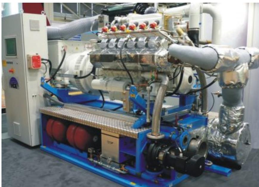
Blockheizkraftwerk – Herzstück einer Biogasanlage
