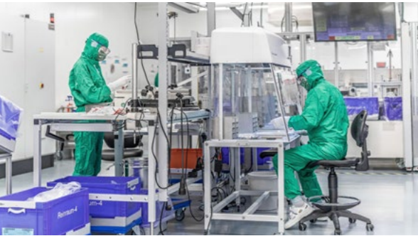
Produktion von PCR-Testkartuschen im Reinraum ISO7 bei RKT GmbH in Roding
